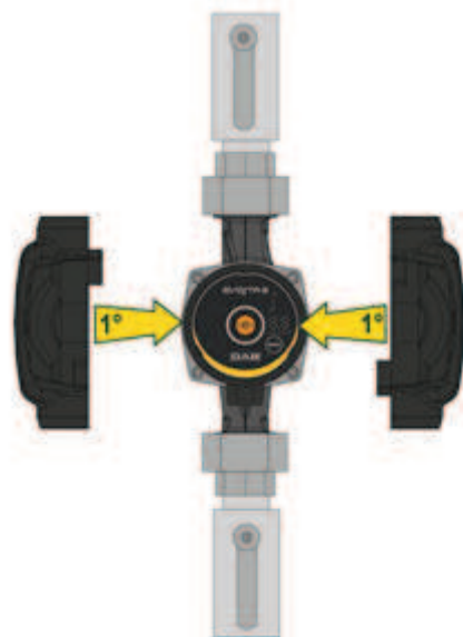
Фигура 7: Изолация на корпуса на помпата
