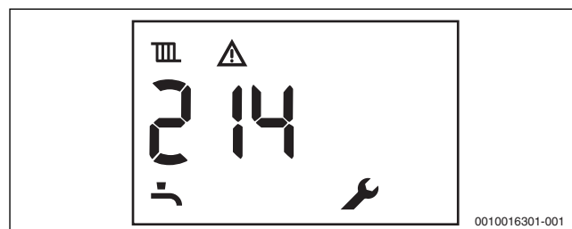
Фиг. 68 Пример: Неблокираща неизправност
